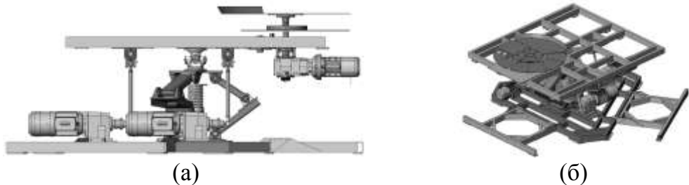
Рис. 3. Платформа с дополнительной независимой степенью свободы
