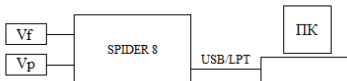
Рис. 6. Принципиальная схема измерительного комплекса исследовательского стенда измерения «мертвого» объема
