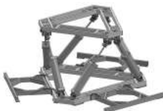
Рис. 4. Динамическая платформа с шестью степенями свободы
